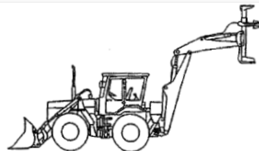
Esempio di terna con attrezzatura per la posa di pali
